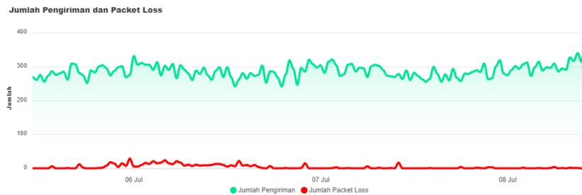
Gambar 16. Grafik Pengujian Jumlah Pengiriman dan *Packet Loss* pada Node *Slave* Ketiga
